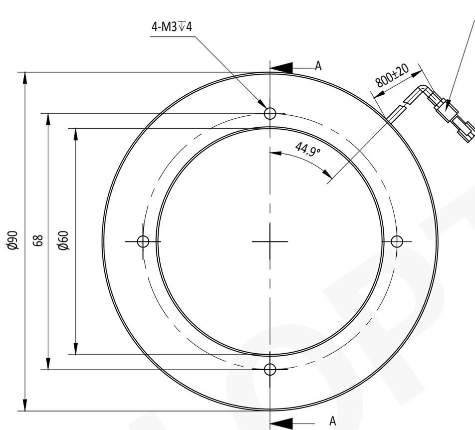
JST 3PIN连接器最小弯曲半径: 20mm
