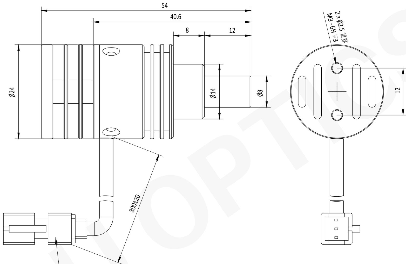
JST 3PIN连接器最小弯曲半径: 20mm
