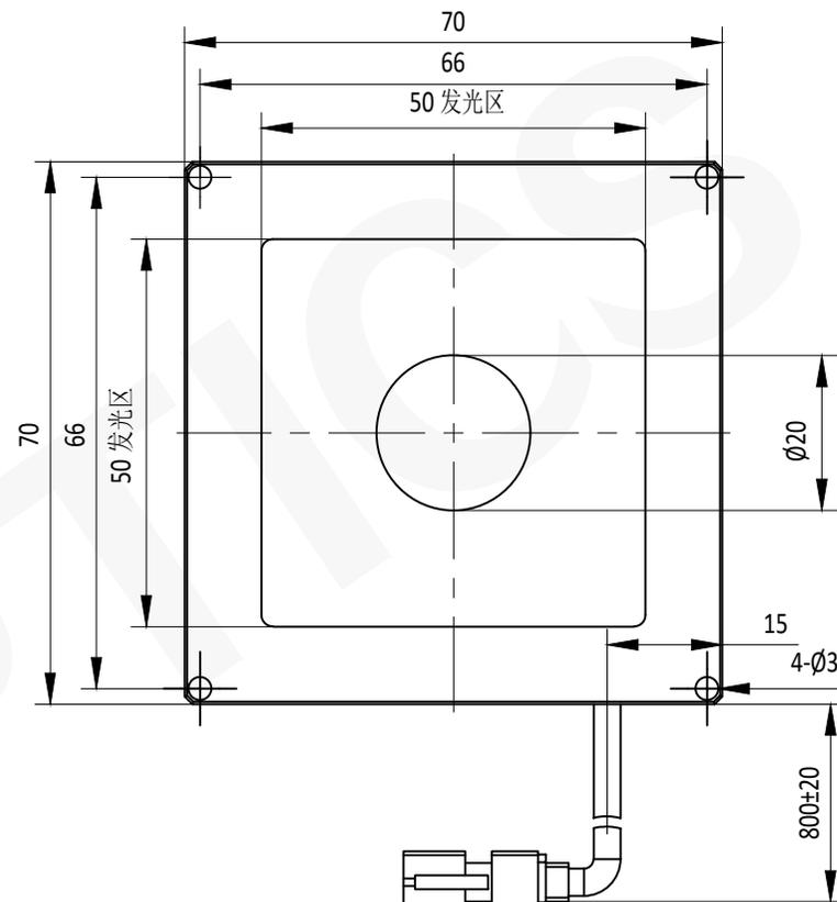
JST 3PIN连接器最小弯曲半径: 20mm
