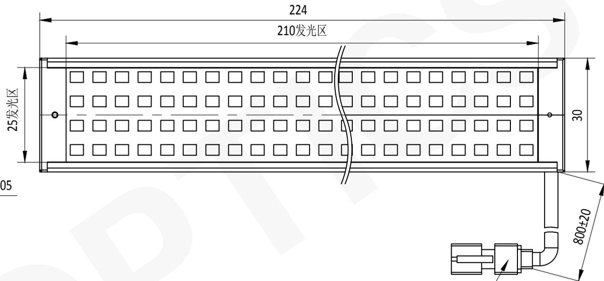
JST 3PIN连接器最小弯曲半径: 20mm
