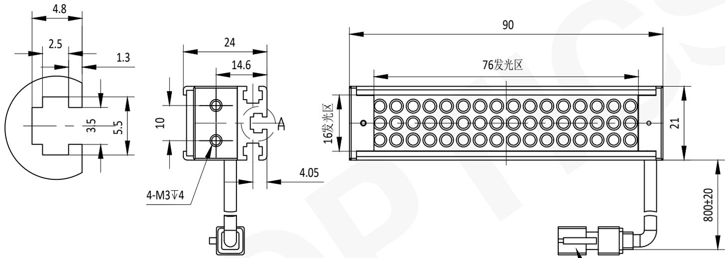
JST 3PIN连接器最小弯曲半径: 20mm
